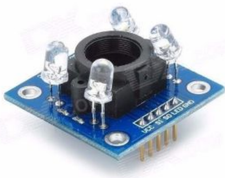
Figura 12. Sensor de cor RGB TCS230
