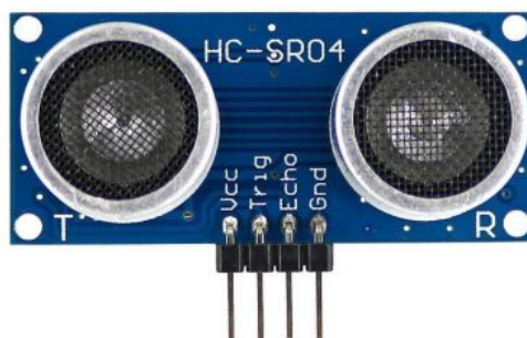
Figura 10. Módulo ultrassônico HC-SR04
