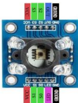
Figura 14 . Pinagem do sensor TCS230
